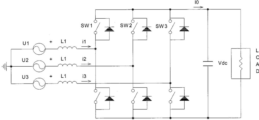
Fig. 1. PWM boost type rectifier.
