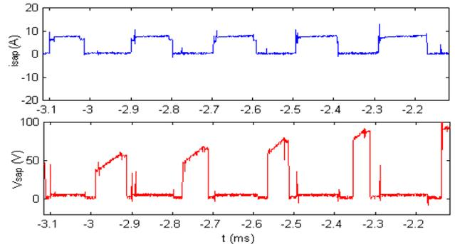
(d) Zero current commutation of line side switch
