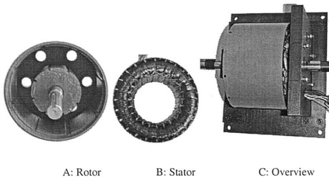
Fig. 12. Prototype machine.
